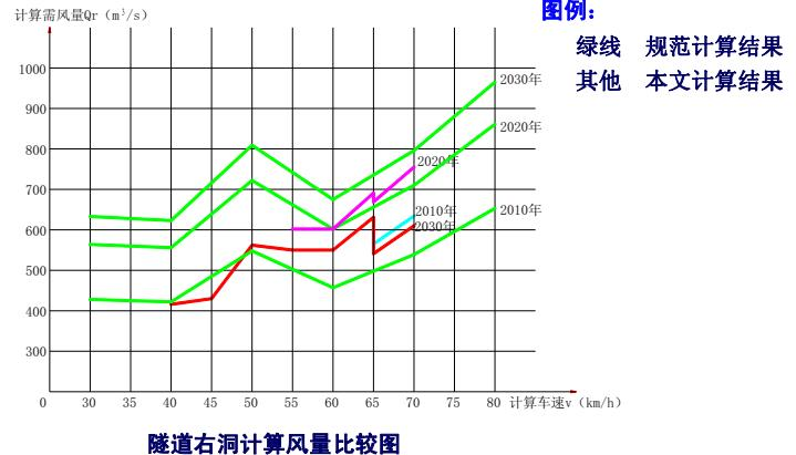
隧道右洞计算风量比较图
