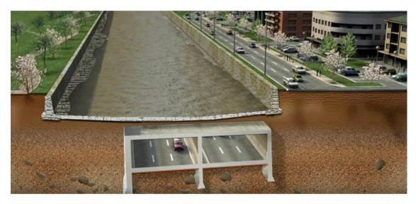
En el tramo de conexión entre los dos túneles, ante la necesidad que la autopista se "hunda" bajo el río, se tiene la mayor pendiente longitudinal de 5,5%. El trazado posee varias curvas que acompañan el río, siendo la de menor radio de 330 metros.
