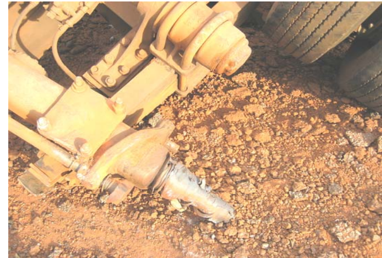
Photo 3 Usure de l'arbre reliant les roues.
