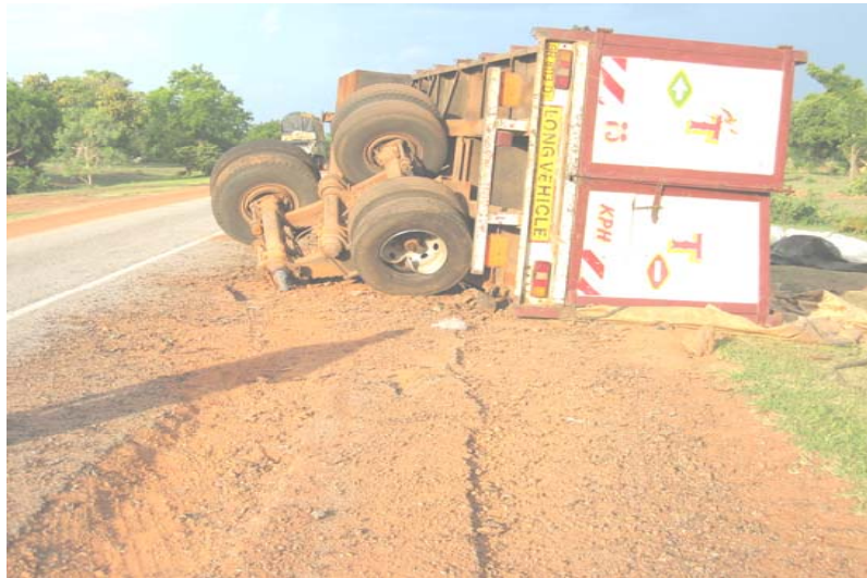
Photo 1 Semi-remorque chargé de 600 sacs de 100kg de mil, soit 60 tonnes. Cause de l'accident : roue déboîtée suite à l'usure.
