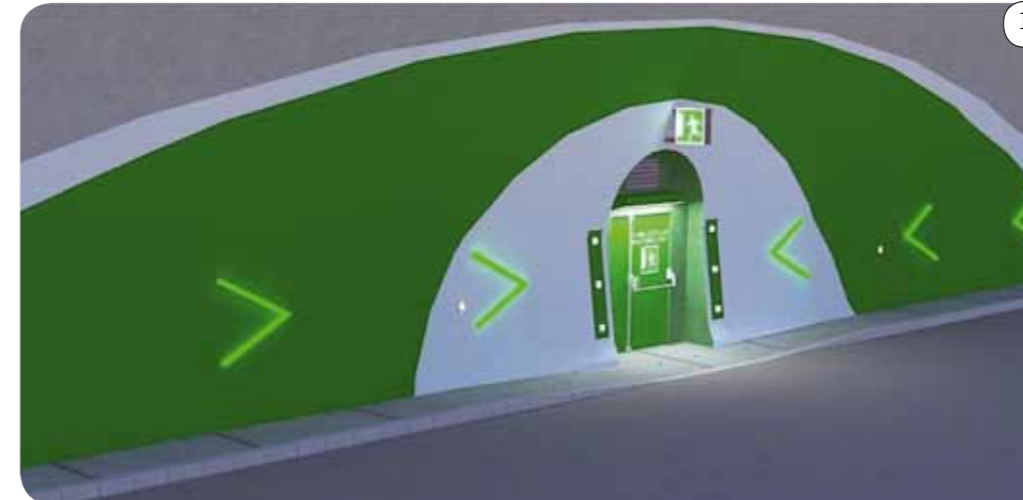
Figure 1 - Exemple de l'intégration d'une issue de secours dans un tunnel routier (France).
